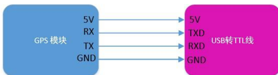
GPS模块和USB转TTL线的接线图
